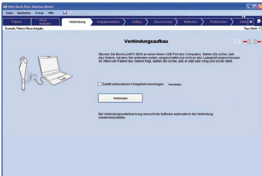
1. Registerkarte **Verbindung** anwählen, um eine Bluetooth®-Verbindung zwischen X-Soft und dem Kniegelenk 3B1/3B1=ST herzustellen. Zur Auswahl des zuletzt verbundenen Kniegelenks das Kontrollfeld **zuletzt verbundenes Kniegelenk bevorzugen** markieren.
